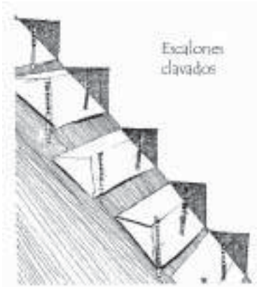
Escalones de madera asegurados a una pared de roca con varillas de acero
