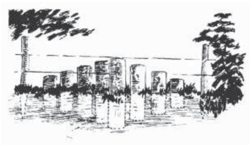
Tranquera de troncos enterrados
