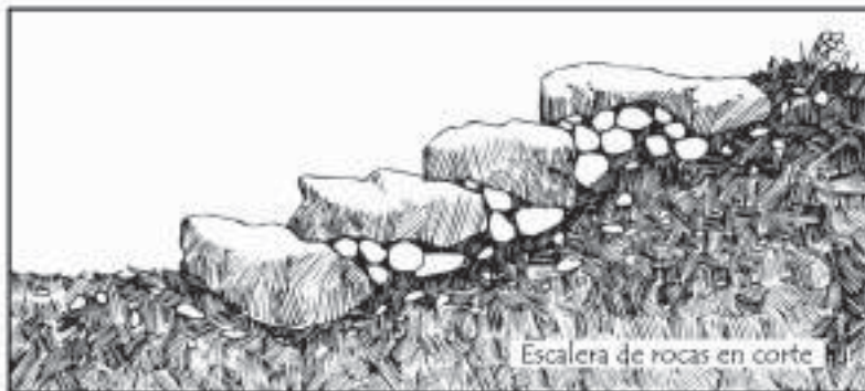
En una escalera sólida, el borde frontal inferior de cada escalón descansa directamente sobre el escalón inferior
