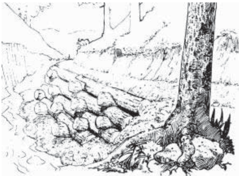
Pared de retención de troncos
